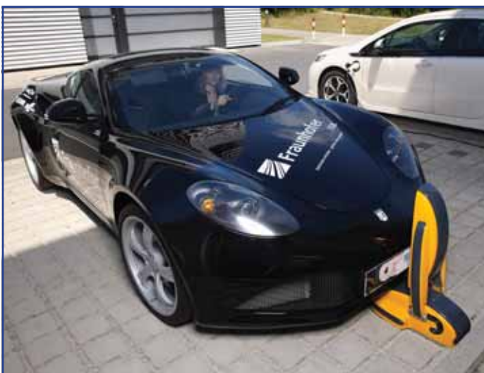
Elektroautos berührungslos via Induktion aufzuladen ist noch Zukunftsmusik. Das Laden von der Vorderseite: Ein neuer Ansatz, der effizient und kostengünstig ist. © Fraunhofer IISB
