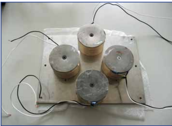
Abbildung 3: Aufbau des Spulenantriebs
