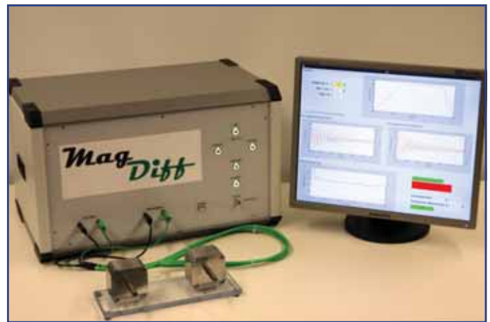
Abb. 6: Gerät MagDiff mit Bildschirm und zwei Stabprobenadapter für Referenzstab und Stabprobe (Prüfling).
