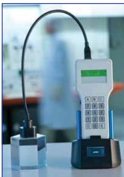
Im Technologielabor für Mikro- und Nanosysteme der HFU hergestellter optischer Biosensor: Messgerät zur Analyse von flüssigen und gasförmigen Substanzen.
